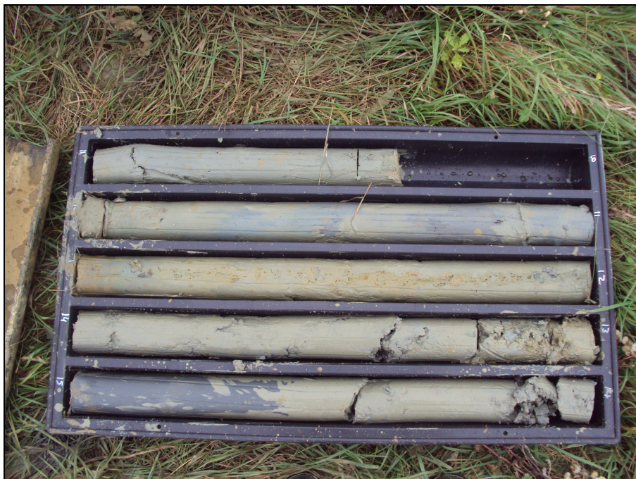
Foto 3: sondaggio S1 – carote da 10 a 15 m di profondità da p.c..
