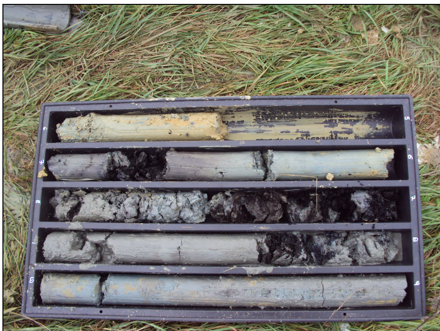
Foto 2: sondaggio S1 – carote da 5 a 10 m di profondità da p.c..
