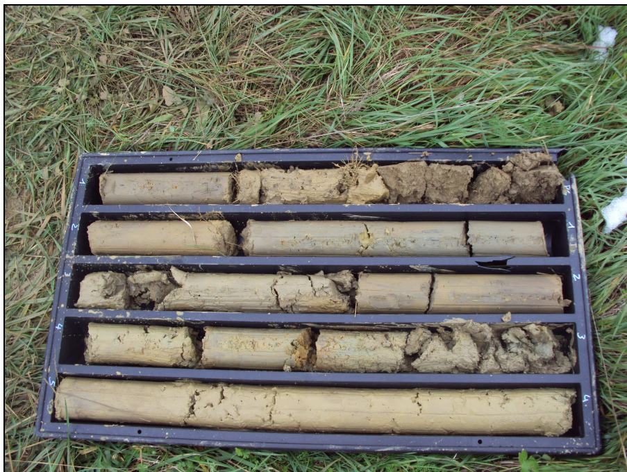
Foto 1: sondaggio S1 – carote da 0 a 5 m di profondità da p.c..
