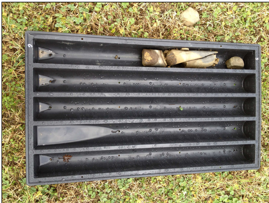
Foto 5: sondaggio S2 – carote da 5 a 5,5 m di profondità da p.c..
