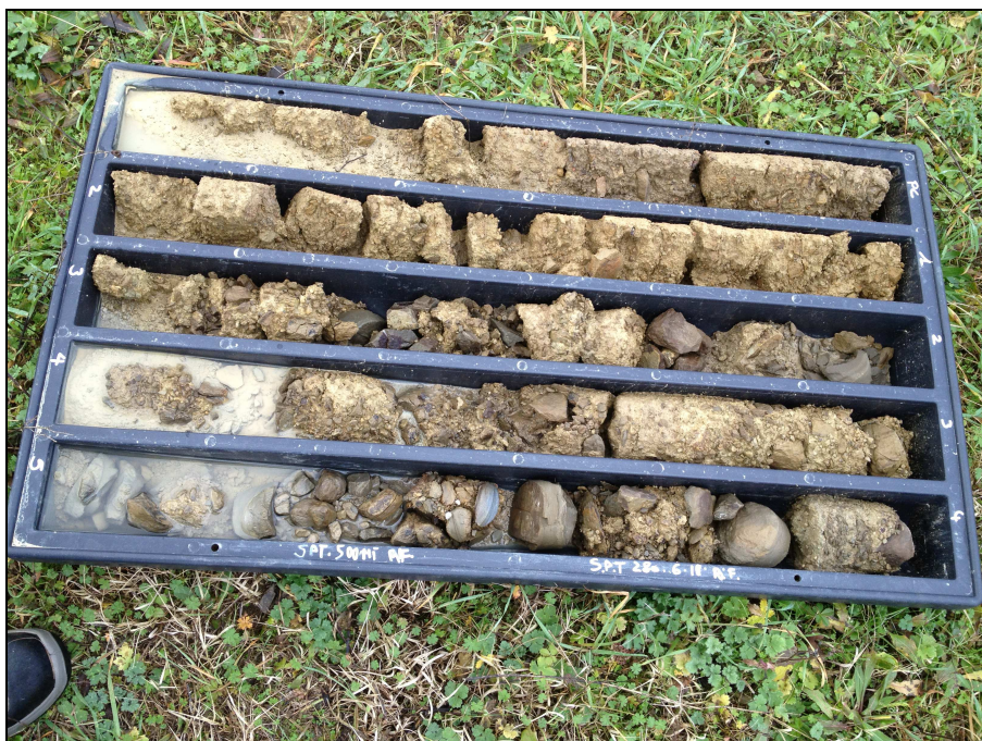
Foto 4: sondaggio S2 – carote da 0 a 5 m di profondità da p.c..
